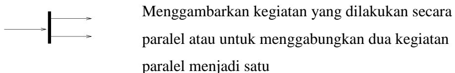
Menggambarkan kegiatan yang dilakukan secara paralel atau untuk menggabungkan dua kegiatan paralel menjadi satu
