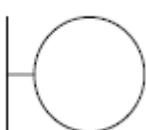
**Boundary** Menggambarkan interaksi antara satu atau lebih *actor* dengan sistem, memodelkan bagian dari sistem yang bergantung pada pihak lain disekitarnya dan merupakan pembatas sistem dengan dunia luar.
