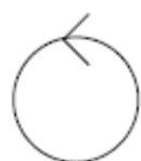
**Control** digunakan untuk mengontrol kelas dari form layar kelas control, mengkoordinasikan perilaku sistem dan menggambarkan dinamika dari suatu sistem, menangani tugas utama dan mengontrol alur kerja suatu kelas.
