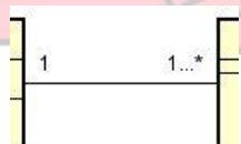
Menggambarkan banyaknya objek yang terhubung satu dengan yang lainnya pada sebuah sistem.
