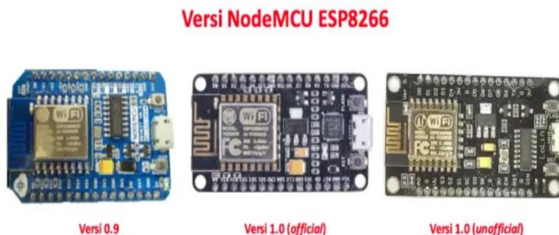
**Gambar 2.2** Bentuk fisik jenis – jenis NodeMCU
