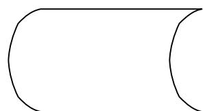
Simbol Stored Data untuk menunjukkan input atau output menggunakan disket atau flash disk
