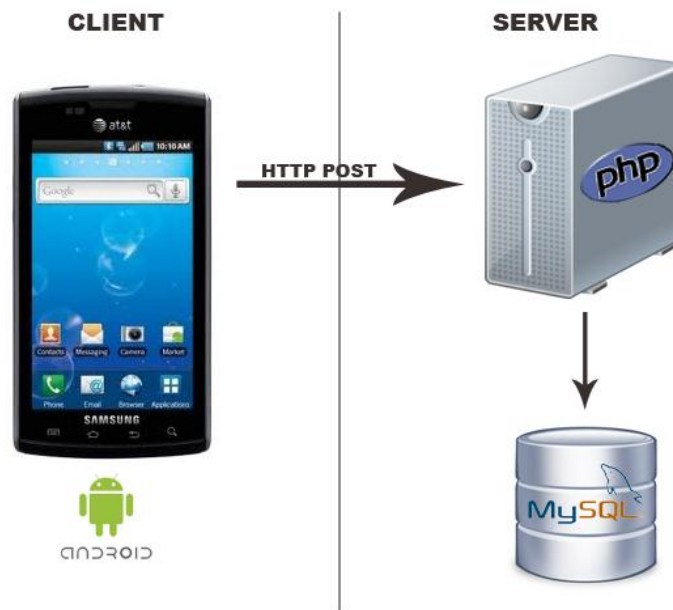
Gambar 2.7 Skema Android-PHP-MySQL menggunakan JSON
